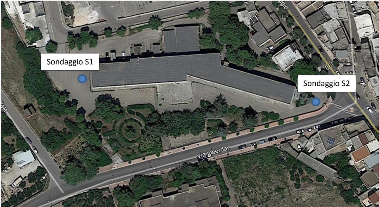
Figura – Ubicazione delle indagini dirette: con i punti in blu sono indicate le posizioni delle perforazioni a carotaggio continuo
